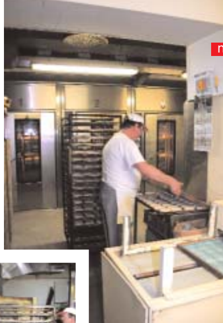
Backen Schuss auf Schuss. Kaum ist der eine Wagen ausgefahren, wird der nächste eingeschoben. Brötchen backen in 20 Minuten bei 230 °C auf 190 °C fallend.
