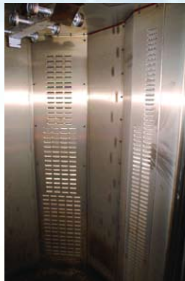
Die ausgeklügelte Luftführung in Verbindung mit dem leistungsstarken Wärmetauscher garantiert gleichmäßige Backergebnisse.
