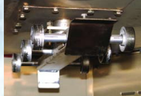
Die Luxrotor Stikkenöfen sind serienmäßig mit einem oben liegenden Antrieb ausgestattet. So liegt die Antriebstechnik außerhalb der heißen Zone und unten kann der Boden sehr gut sauber gehalten werden. Ein Umrüsten auf jeden anderen Wagentyp ist aber möglich.
