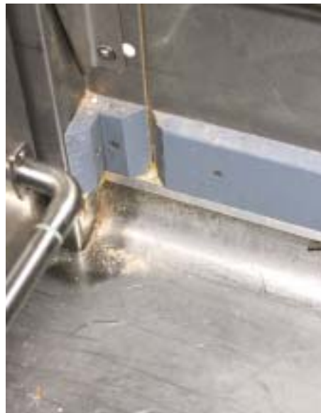
Der 3 mm starke Edelstahlboden ist als dichte Wanne mit hochgezogenen Ecken verschweißt.
